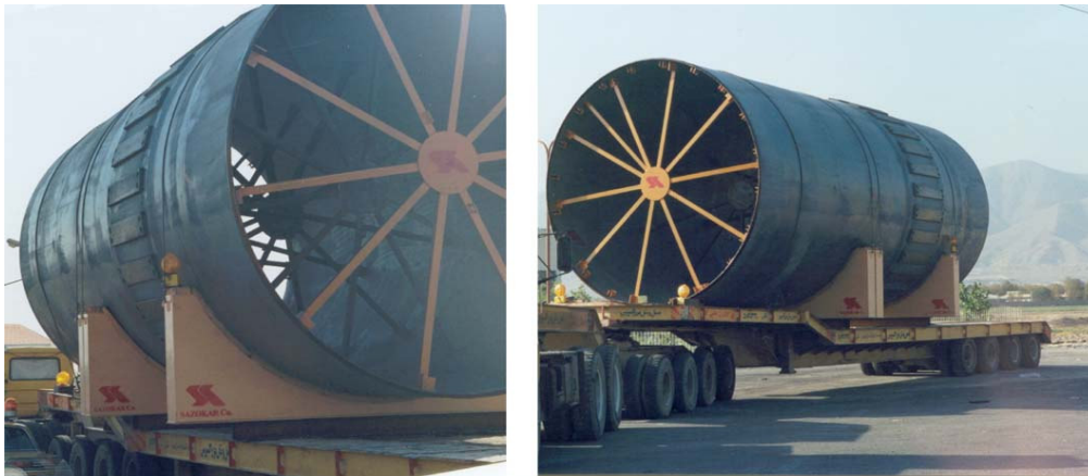
تصویر شماره (۶-۵) : روش مهار بار خاص توسط زین
