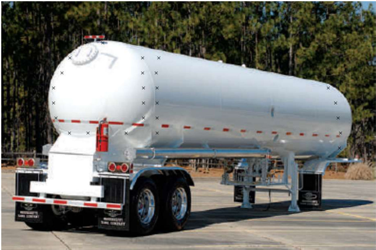
شکل ت-۱- نقاط و سطوح پیشنهادی جهت انجام آزمون سختی سنجی مخزن
